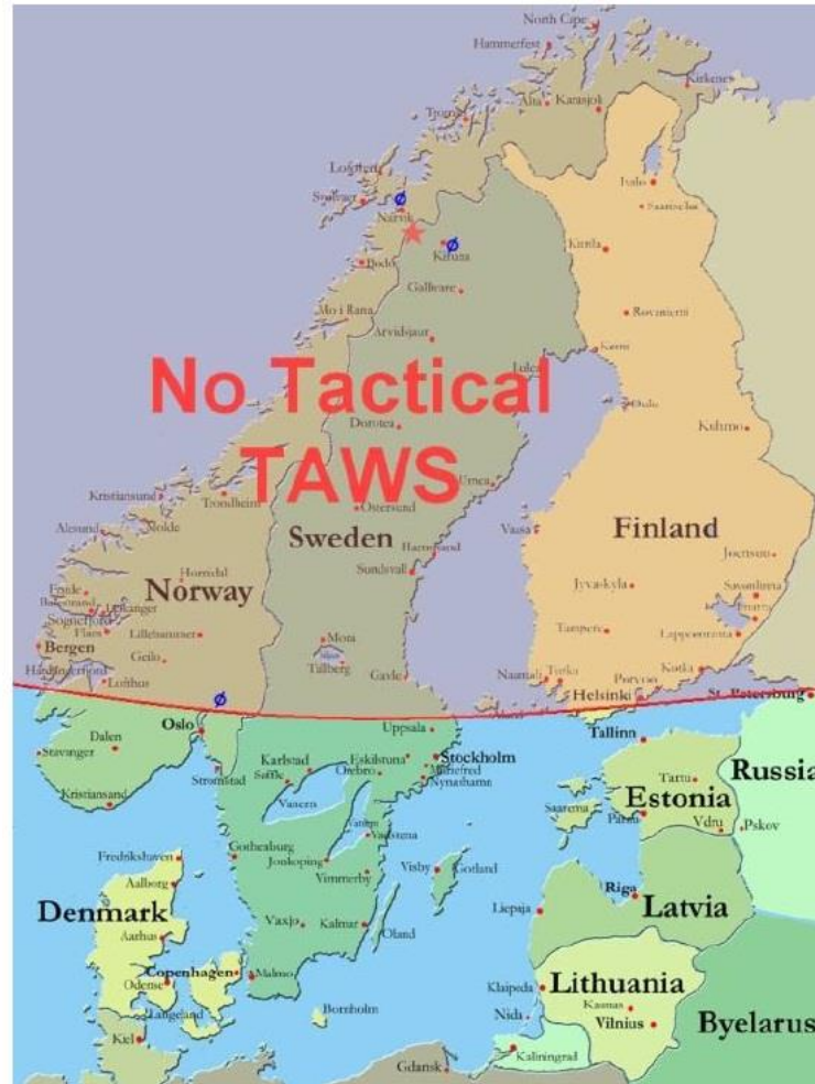
Fig 4: Kartbild över Skandinavien. I det rödmarkerade området har TAWS i läge Tactical ingen terrängvarningsfunktion. Haveriplatsen är markerad med en röd stjärna.
